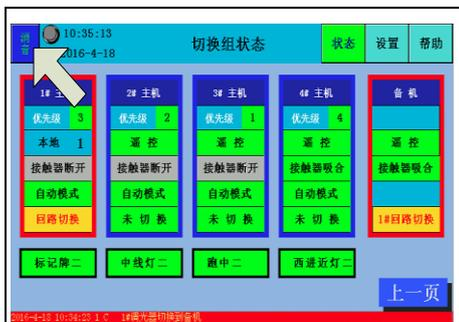
4. 此时 1 号调光器负载切换至备调光器输出，切换柜有声光报警，蜂鸣器响，状态页面中有切换报警指示，按左上角的消音键消音，在备调光器上开机。
