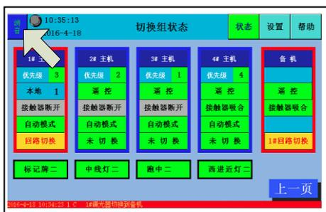
5. 切换柜自动切换, 备调光器开启, 代替 1 号调光器工作并自动跟踪光级。切换柜有声光报警, 蜂鸣器响, 状态页面中有切换报警指示, 按左上角消音键消音。
