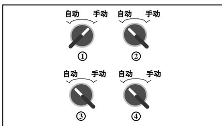
3. 给切换柜上电并将 1 号旋钮设置在手动位置。
